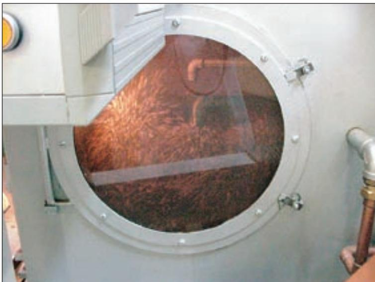
Este aglomerado caliente y húmedo pasa por una criba preliminar. Se selecciona el aglomerado de tamaño adecuado, que se seca inmediatamente en lecho fluido y pasa por un tamizado final a través de cribas de determinada luz de malla, que permiten ajustar el tamaño del aglomerado a las especificaciones de producto.
