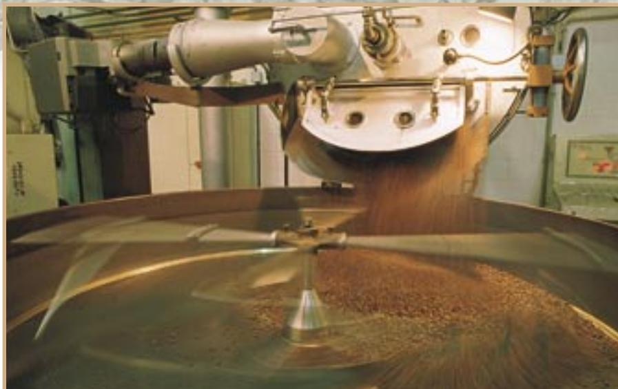
Se construye este tipo de molino con capacidades de molturación de hasta 500 kg por hora.
