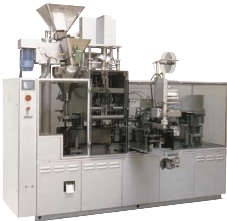
El proceso de sellado se inicia con el calentamiento del material a sellar hasta conseguir que se fusione. Cuando ya está fundido, se pone en contacto con otro elemento de la misma naturaleza para que quede pegado, dejándolo entonces enfriar. Al recobrar la temperatura ambiente, la soldadura gana fuerza, convirtiéndose en definitiva.
